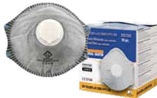
DS7322 FFP2 - NR EN149:2001 +A1:2009 Mascarilla filtrante para polvo tóxico , nieblas y humo con base acuosa. El nivel de protección igual a 12 veces el TLV (valor límite de exposición). La mascarilla tiene una válvula de exhalación y de una capa intermedia de carbón activo . Aconsejable para humos de soldadura ligera y trabajos con olores desagradables . Talla: única. Embalaje: 12 cajas de 10 piezas c.u. Pedido mínimo: 1 caja de 10 piezas.
